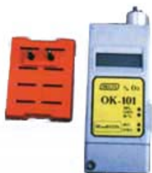
Рис. 86. Общий вид газоанализатора-сигнализатора ОК-101
